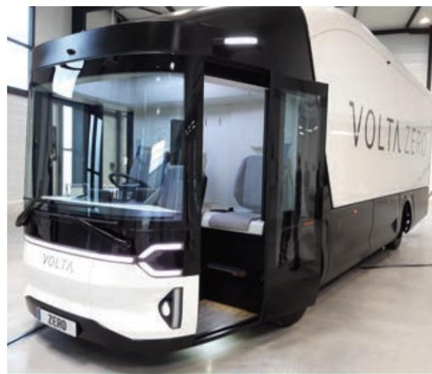
Le Volta Zero (ici le 16 tonnes) est équipé d'un châssis entièrement conçu pour l'électrique ce qui lui évite 90 % des pièces nécessaires sur un camion diesel.
