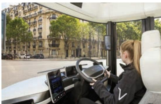
Cabine de conduite rabaisée comme sur les bus, volant placé au centre, larges surfaces vitrées et caméras pour déboucher les angles morts : le Volta Zero cherche à renforcer le confort des chauffeurs et la sécurité des usagers de la voirie.
